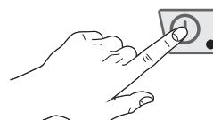
Le témoin du bouton A marche/arrêt s'allume, indiquant que le lave-vaisselle est alimenté et que l'eau est introduite et chauffée. Le mot " FILL " défile sur l'écran durant la totalité de la phase de remplissage et de chauffe.
