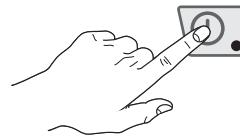
Se enciende la luz piloto del botón "A" (Figura 14), que indica la puesta en marcha del lavavajillas la carga y calentamiento del agua. "FILL" se muestra en movimiento en el display durante toda la fase de llenado y calentamiento.
