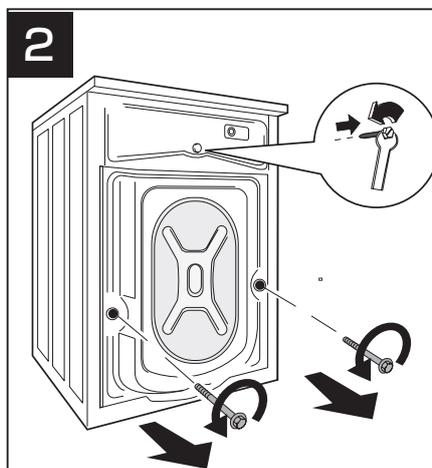
本体を起し、必ずドラムを固定している輸送用ボルト3点を、付属しているスパナで取外してください。
