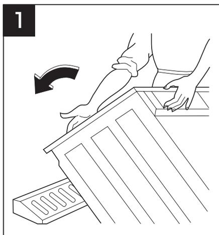
運送箱を完全に解いてから洗濯機を寝かして、機械の下にあるポリスチレンのベースを取り除いてください。
