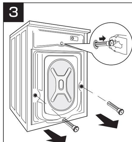
輸送用ボルトを外した後、固定ピンを全て取外してください。
