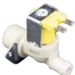
0E5070 Électrovanne 24V simple 180° entrée Ø 3/4" libre sortie Ø 14mm libre température 90 °C max. bobine 24 V 50 Hz
