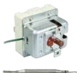
005931 Thermostat monophasé 250 °C capillaire 900 mm bulbe Ø6x87 mm 0,5A, 12V
