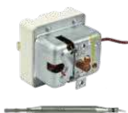
002711 Thermostat monophasé 150 °C bulbe Ø6x74 mm capillaire 1700 mm 20A 400V
