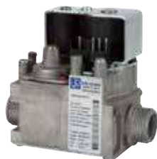
0C7600 Vanne à gaz 840 SIGMA entrée-sortie Ø 3/4" M Alimentation 230V 50Hz plage rég.pression 2-50mbar
