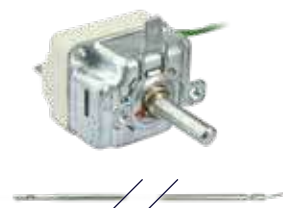
056384 Thermostat monophasé 50-296 °C capillaire 1000 mm bulbe Ø3x219 mm 16A 380V axe manette Ø6x4,6 mm
