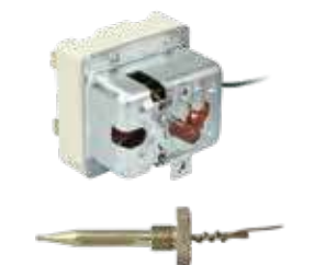
007042 Thermostat monophasé 338 °C bulbe Ø6x39 mm capillaire 900 mm 20A 400V
