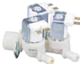
0F0001 Électrovanne triple 180° entrée Ø 3/4" sortie Ø 10 mm réducteur jaune 2,5 l/min - rouge 0,25 l/min température 90 °C max. bobine 220/240 V 50/60 Hz
