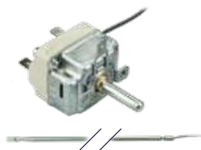
033716 Thermostat monophasé 30-90 °C bulbe Ø6x100 mm capillaire 960 mm 16A 230V axe manette Ø6x4,6 mm
