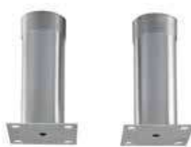
0C9565 Pied à bride pour fixation au sol LOT 2 pièces en AISI 304 base 80x80 mm entraxe 60x60 mm raccord fileté 1" \frac{3}{4} Ø 50,5 mm hauteur 140mm - utile 100mm Compatible avec 0C0204
