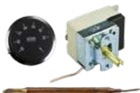
033716 Thermostat monophasé 30-90 °C bulbe Ø6x100 mm capillaire 960 mm 16A 230V axe manette Ø6x4,6 mm
