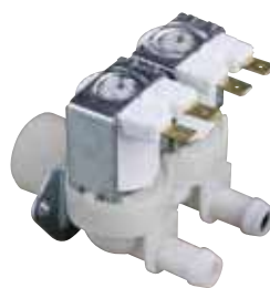
047536 Électrovanne double 180° entrée Ø 3/4" 20 l/min sortie Ø 10 mm réducteur noir 5 l/min température 90 °C max. bobine 220/240 V 50/60 Hz
