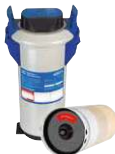
OS0803 Système de filtration PURITY 1200 EXTRA avec déminéralisation TOTALE avec cartouche filtre. Raccords : entrée G1"- sortie G3/4" Pression d'entrée mini/max. : 2-6 bar Température de service 4 °C-60 °C Capacité : 5 000 l à 10 °KH
