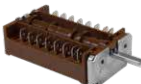
004741 Commutateur à cames 0-6 pos 7 positions de commande - 7 pôles portée des contacts 16A-250V tige demi-lune Ø 6x4,6 mm longueur axe 23 mm raccords faston 6,3x0,8mm
