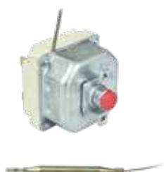
006433 Thermostat triphasé 150 °C bulbe Ø6x73 mm capillaire 1730 mm 0,5A 12V
