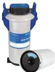
OS0801 Système de filtration PURITY 1200 CLEAN avec déminéralisation PARTIELLE avec cartouche filtre. Raccords : entrée G1"- sortie G3/4" Pression d'entrée mini/max. : 2-6 bar Température de service 4 °C-60 °C Capacité : 13 000 l à 10° KH
