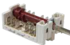
002661 Commutateur à cames 0-6 pos 7 positions de commande - 5 pôles portée des contacts 16A-250V tige demi-lune Ø 6x4,6 mm longueur axe 23 mm raccords faston 6,3x0,8mm
