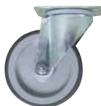
087111 Roue pivotante à plaque sans frein plaque de fixation dim. 105x85 mm entraxe orifices 80/77 x 60 mm dim. Ø 125x32 mm Pour kit PNC 880025
