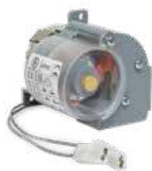
094755 Temporisateur pour dégivrage cycle journalier de 1 à 12 dégivrages retard hélices réglables INTC/PTC Alimentation 230V 50Hz dim.72x88x70h mm
