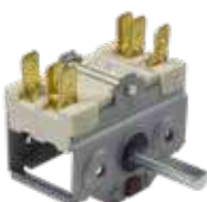
054375 Commutateur à cames 0-1 pos auxiliaire 2 positions de commande - 2 pôles portée des contacts 16A-250V tige demi-lune Ø 6x4,6 mm longueur axe 23 mm raccords faston 6,3x0,8mm
