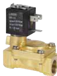
0L0423 Électrovanne 2 voies 3/8" FF 230V 50-60Hz pour l'eau température mini/max. 0/+140 °C pression mini/max. 0,35/16 bar bobine type ZB14A 230V 50-60Hz 12VA 4W
