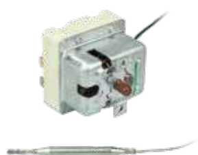
OC1147 Thermostat monophasé 150 °C bulbe Ø6x74 mm capillaire 1700 mm 0,5A 12V
