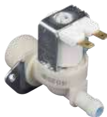
002753 Électrovanne simple 180° entrée Ø 3/4" libre sortie Ø 10 mm réducteur bleu 1l/min température 90 °C max. bobine 220/240 V 50/60 Hz
