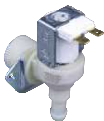
055350 Électrovanne simple 90° entrée Ø 3/4" libre sortie Ø 10 mm réducteur bleu 1l/min température 90 °C max. bobine 220/240 V 50/60 Hz
