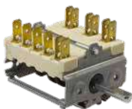
OH6685 Commutateur à cames 0-6 pos 7 positions de commande - 3 pôles portée des contacts 16A-250V tige demi-lune Ø 6x4,6 mm longueur axe 23 mm raccords faston 6,3x0,8mm
