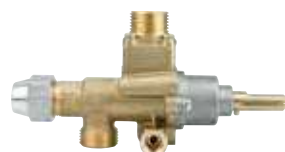
052432 Robinet gaz PEL 22 V avec veilleuse et bride verticale raccords ØM20x1,5 mm raccord thermocouple M9x1 vis d'ouv. mini Ø 0,30 mm tige demi-lune Ø 10x8 mm
