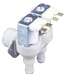
055444 Électrovanne double 90° entrée Ø 3/4" libre sortie Ø 10 mm réducteur bleu 1l/min température 90 °C max. bobine 220/240 V 50/60 Hz
