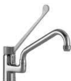
Robinet monotrou avec levier raccord arrivée d'eau Ø1/2"G orifice de fixation Ø3/4" bec Ø 25x225 mm
