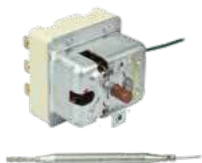
OC2983 Thermostat triphasé 140 °C bulbe Ø6x87 mm capillaire 900 mm 20A 400V
