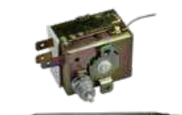
058164 Thermostat monophasé 230 °C bulbe Ø6x130 mm capillaire recouvert 1000 mm 16A, 250V avec câblage thermocouple
