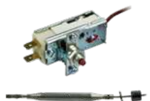
003121 Thermostat monophasé 240 °C bulbe Ø6x80 mm capillaire recouvert 1300 mm 16A 250V raccord presse-étoupe M10x1
