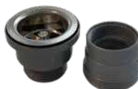
0S1319 Bonde de vidange Ø 50 mm corps en plastique et filtre en acier raccord 1 1/2" avec adaptateur 2"
