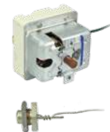
002730 Thermostat monophasé 338 °C bulbe Ø11x6 mm capillaire 900 mm 20A 400V
