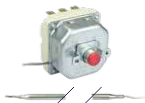
OS2623 Thermostat triphasé 140 °C bulbe Ø6x175 mm capillaire 830 mm 20A 380V
