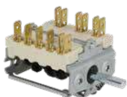
053408 Commutateur à cames 0-6 pos 7 positions de commande - 6 pôles portée des contacts 16A-250V tige demi-lune Ø 6x4,6 mm longueur axe 23 mm raccords faston 6,3x0,8mm
