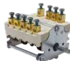
0C3936 Commutateur à cames 0-6 pos 7 positions de commande - 7 pôles portée des contacts 16A-250V tige demi-lune Ø 6x4,6 mm longueur axe 23 mm raccords à vis
