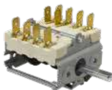
032677 Commutateur à cames 0-1 pos 2 positions de commande - 4 pôles portée des contacts 16A-250V tige demi-lune Ø 6x4,6 mm longueur axe 23 mm raccords faston 6,3x0,8mm
