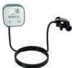
OS2556 Compte-litres numérique volumétrique Débitmètre 100-700A débit 100-700 l/h temp. 4 °C - 30 °C max. 8 bar Indique les litres résiduels que le système de filtration est en mesure de traiter Alimentation par batterie
