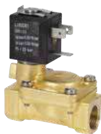
0L0423 Électrovanne 2 voies 3/8" FF 230V 50-60Hz pour l'eau température mini/max. 0/+140 °C pression mini/max. 0,35/16 bar bobine type ZB14A 230V 50-60Hz 12VA 4W
