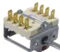
0A2134 Commutateur à cames 0-1 pos auxiliaire 2 positions de commande - 4 pôles portée des contacts 16A-250V tige demi-lune Ø 6x4,6 mm longueur axe 23 mm raccords faston 6,3x0,8mm
