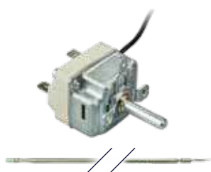
054323 Thermostat monophasé 0-300 °C bulbe Ø3,5x190 mm capillaire 1500 mm 15A 230V axe manette Ø6x4,6 mm
