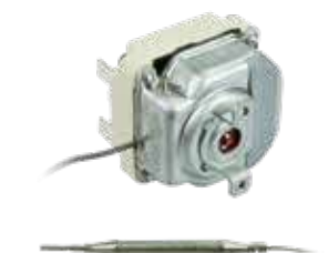
0C0999 Thermostat monophasé 260 °C bulbe Ø6x75 mm capillaire 1250 mm 0,5A 12V
