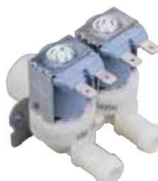
048180 Électrovanne 24V double 180° entrée Ø 3/4" libre sortie Ø 14mm libre température 90 °C max. bobine 24 V 50 Hz
