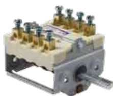
026945 Commutateur à cames 0-1 pos 2 positions de commande - 4 pôles portée des contacts 16A-250V tige demi-lune Ø 6x4,6 mm longueur axe 23 mm raccords à vis trou arrière pour thermostat
