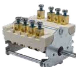
006649 Commutateur à cames 0-1 pos 2 positions de commande - 4 pôles portée des contacts 32A-250V tige demi-lune Ø 6x4,6 mm longueur axe 23 mm raccords à vis
