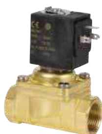
OL1481 Électrovanne 2 voies 3/4" FF 24V 50-60Hz pour vapeur température mini/max. +60/+170 °C pression mini/max. 0,4/6 bar bobine type Z534A 24V 50-60Hz 14VA
