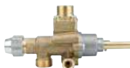
0C0489 Robinet gaz PEL 22 V avec veilleuse et bride verticale raccords ØM20x1,5 mm raccord thermocouple M9x1 tige demi-lune Ø 10x8 mm longueur axe 33,5 mm
