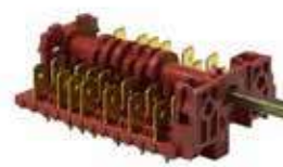
0C3936 Commutateur à cames 0-6 pos 7 positions de commande - 7 pôles portée des contacts 16A-250V tige demi-lune Ø 6x4,6 mm longueur axe 23 mm raccords à vis
