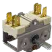
003142 Commutateur à cames 0-1 pos 2 positions de commande - 2 pôles portée des contacts 16A-250V tige demi-lune Ø 6x4,6 mm longueur axe 23 mm raccords faston 6,3x0,8mm
