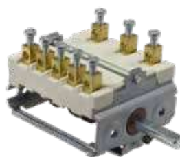
OA2021 Commutateur à cames 0-6 pos 7 positions de commande - 3 pôles portée des contacts 16A-250V tige demi-lune Ø 6x4,6 mm longueur axe 23 mm raccords à vis
