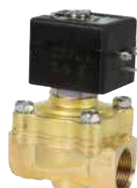
OK8129 Électrovanne 2 voies 3/4" FF 24V 60Hz pour eau chaude/vapeur température mini/max. -10/+140 °C pression vapeur mini/max. 0,35/3,5 bar pression eau chaude mini/max. 0,35/10 bar bobine type MXX-HT 24V 60Hz 10,5W
