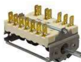
0K4914 Commutateur à cames 0-6 pos 7 positions de commande - 5 pôles portée des contacts 16A-250V tige demi-lune Ø 6x4,6 mm longueur axe 23 mm raccords faston 6,3x0,8mm
