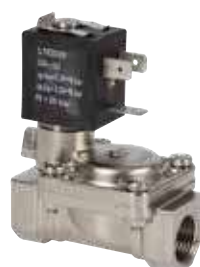
OL2656 Électrovanne 2 voies 3/8" FF 208-240V 50-60Hz pour l'eau température mini/max. -10/+140 °C pression mini/max. 0,35/16 bar bobine type ZB14Y 208-240V 50-60Hz 12VA
