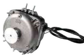
OS1119 Motoventilateur pentavalent 5 types de fixation avec câble Rpm 1300/1550 Puissance sortie/entrée 18/73W 230/240 V 50-60Hz
