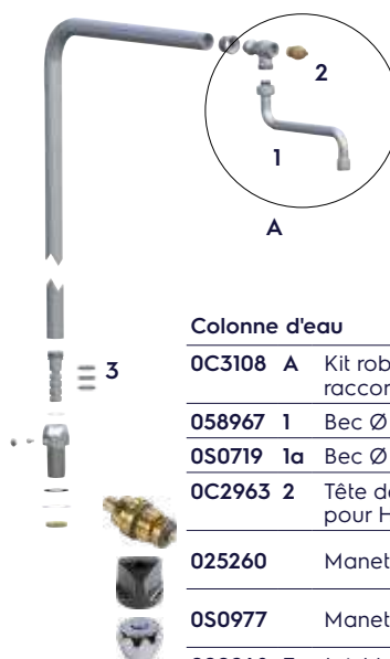
OC9108 Colonne d'eau orientable pour cuisinière séries 700-900 avec plaques de fixation (sans tuyaux d'extension) H=700
