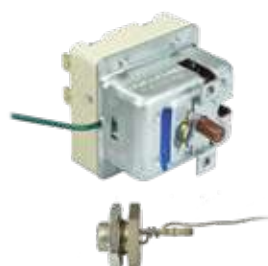
005680 Thermostat monophasé 338 °C bulbe Ø11x6 mm capillaire 900 mm 20A 400V
