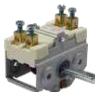
028390 Commutateur à cames 0-1 pos 2 positions de commande - 2 pôles portée des contacts 16A-250V tige demi-lune Ø 6x4,6 mm longueur axe 23 mm raccords à vis
