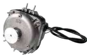
OS0563 Motoventilateur pentavalent 5 types de fixation avec câble Rpm 1300/1550 Puissance sortie/entrée 25/95W 230/240 V 50-60Hz
