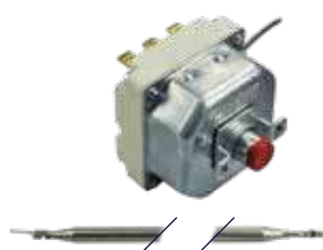
059552 Thermostat triphasé 225 °C bulbe Ø6x159 mm capillaire 940 mm 20A 380V
