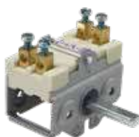
0K8420 Commutateur à cames 0-1 pos 2 positions de commande - 2 pôles portée des contacts 16A-250V tige demi-lune Ø 6x4,6 mm longueur axe 23 mm raccords à vis, trou arrière pour thermostat
