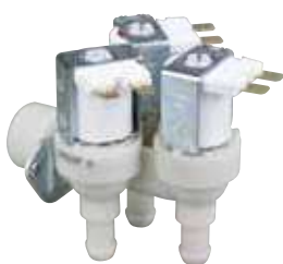
002712 Électrovanne triple 90° entrée Ø 3/4" libre sortie Ø 10 mm réducteur rouge 0,25 l/min température 90 °C max. bobine 220/240 V 50/60 Hz
