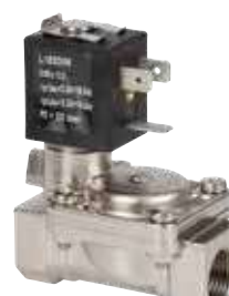
OL2857 Électrovanne 2 voies 3/8" FF 200V 50-60Hz pour l'eau température mini/max. -10/+140 °C pression mini/max. 0,35/20 bar bobine type ZB14A 200V 50-60Hz 12VA
