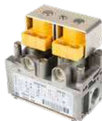
005526 Vanne à gaz 830 TANDEM entrée-sortie Ø1/2" F plage rég. pression 3÷50 mbar Alimentation 24V 50Hz température ambiante 0 °C à 60 °C
