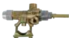
0C0205 Robinet gaz PEL 21S avec veilleuse et bride spéciale raccord entrée Ø 9mm raccord sortie ØM16x1,5 mm raccord thermocouple M8x1 tige demi-lune Ø 8x6,5 mm
