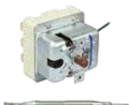
005295 Thermostat triphasé 170 °C bulbe Ø6x87 mm capillaire 900 mm 0,5A 12V
