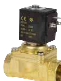
OL1482 Électrovanne 2 voies 3/4" FF 230V 50-60Hz pour vapeur température mini/max. +60/+170 °C pression mini/max. 0,4/6 bar bobine type Z534A 230V 50-60Hz 14VA
