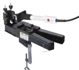
006956 Soudeuse courroies rondes (à louer) Polycord Instrument utile et nécessaire pour souder les courroies des bandes de transport plateaux Ø mini de 2mm à 15mm Tension 230V, 50Hz dim. 420x140x115h Poids 0,68 kg (location possible, pour la procédure, s'adresser directement au siège).
