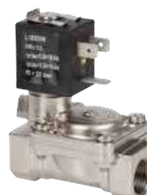
OL2516 Électrovanne 2 voies 3/8" FF 24V 50-60Hz pour l'eau température mini/max. -10/+140 °C pression mini/max. 0,35/16 bar bobine type ZB14A 24V 50-60Hz 12VA 4W
