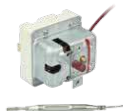
004354 Thermostat monophasé 240 °C bulbe Ø6x79 mm capillaire 2000 mm 0,5A 12V
