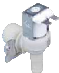
048178 Électrovanne simple 90° entrée Ø 3/4" 20 l/min sortie Ø 14 mm libre température 90 °C max. bobine 220/240 V 50/60 Hz
