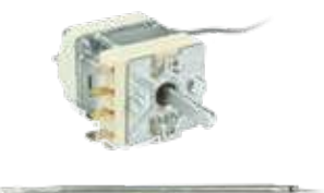
002109 Thermostat monophasé 50-260 °C avec commutateur auxiliaire bulbe Ø4x115 mm capillaire 1300 mm 10A 400V axe manette Ø6x4,6 mm
