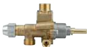
052146 Robinet gaz PEL 22 V avec veilleuse et bride verticale raccords ØM20x1,5 mm raccord thermocouple M9x1 tige demi-lune long. 26,5 mm Ø 10x8 mm
