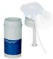
OS1892 Cartouche de service Purity C pour le nettoyage, la désinfection et le détartrage des équipements directement connectés. ▶ Ø 125 mm - H 233 mm ▶ Capacité maximum de la cartouche 0.5 L ▶ Pression de service 0.5-8.6 bar ▶ Température d'arrivée de l'eau 4-30 ° C ▶ La cartouche n'inclut pas la tête OS1638
