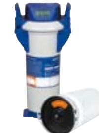
OS1632 Filtre VAPEUR Purity 450 avec MDU - système de compteur de litres inclus Capacité 3,680 L à 10° dH avec by-pass à pos.1 ▶ Temp. de travail 4°C-30°C ▶ Pression max. 6.9 bar ▶ Connexion tête d'entrée/sortie G1" - G3/4" ▶ Dim. Ø249x408h
