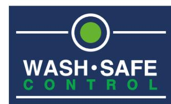
La fonction **Wash-Safe Control** passe au vert pour indiquer que le cycle de rinçage a été correctement effectué avec une température constante supérieure à 84 °C.
