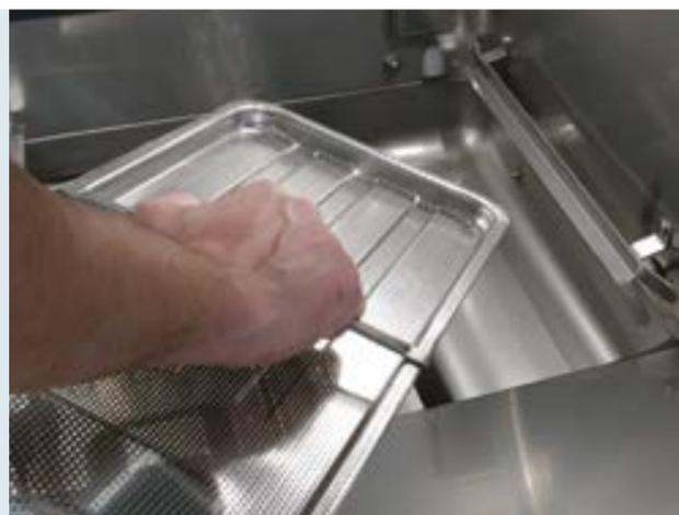
**Les filtres du réservoir de lavage peuvent être facilement retirés sans avoir à enlever les bras de lavage et de rinçage.**
