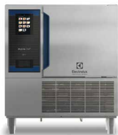
30/30 kg – 6GN 1/1 Ulkomitat (LxSxK) 897 x 937 x 1060 mm Sähköteho - 3,4 kW Kylmäaine: R290 (keskukonemalli: R452A*)
