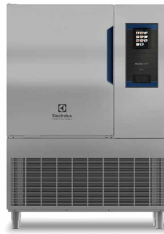
100/70 kg – 10GN 2/1 Ulkomitat (LxSxK) 1250 x 1092 x 1730 mm Sähköteho - 5,8 kW Kylmäaine: R290 (keskukonemalli: R452A*)
