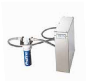
OS1822 Filtro de ósmosis inversa voltaje de alimentación: 220... 240 V / 1N ph / 50/60 Hz consumo de energía 0,18 kw presión de agua de alimentación: 1 - 4 bar temperatura del agua del suministro eléctrico: 5-35 ° C medidas del tubo de entrada de agua: 3/4 "
