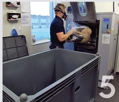
Bringen Sie die Wäschesäcke in den "roten Bereich" der Wäscherei und befüllen Sie die Barriere-Waschmaschine.
