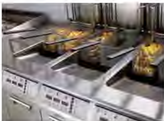
Einteiliges, gepresstes Becken. Dargestelltes Modell mit jeweils 23 Liter Füllvolumen.
