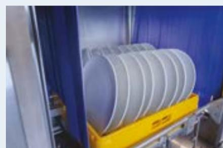
**Fonctionnement automatique en douceur** grâce à une distance optimale entre le rideau et le bras de rinçage. De cette façon, les rideaux ne bloquent pas le bras supérieur, afin de garantir un recouvrement complet du casier par l'eau de rinçage.
