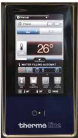
Benutzeroberfläche mit automatischer Füllfunktion.
